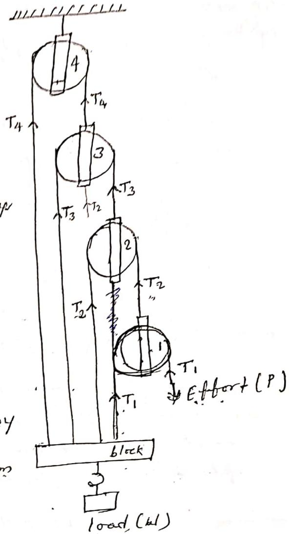
$$W = T_1 + T_2 + T_3 + T_4 \quad \text{--- (1)}$$
