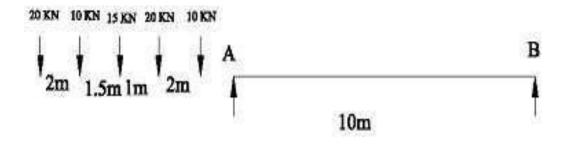
1. Absolute max +ve S.F 2...Absolute max -ve S.F 3..Absolute max BM 10 KN 50 KN 20 KN 10 KN 1 KN 1
