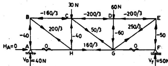
Figure 11.5 (d) : P-forces in Truss Members
